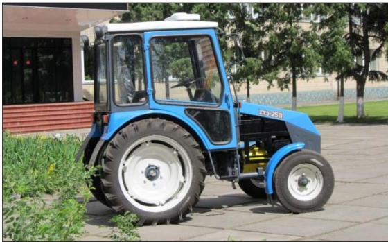
Рис. 1. Електротрактор на базі трактора ХТЗ-2511
