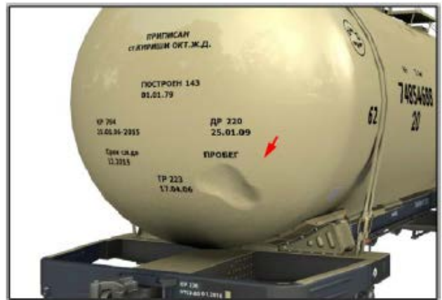
Рис. 3. Пошкодження котла цистерни
