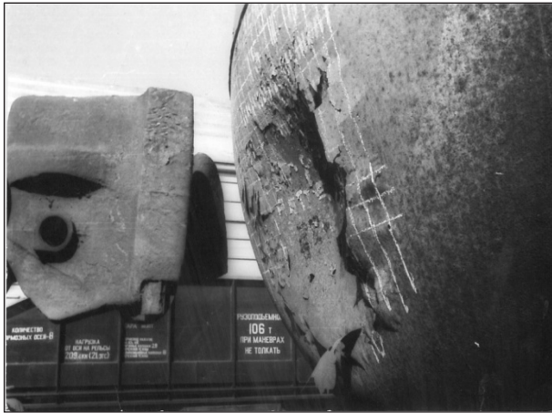
Рис. 8. Дослідний зразок після удару в котел автозцепом
